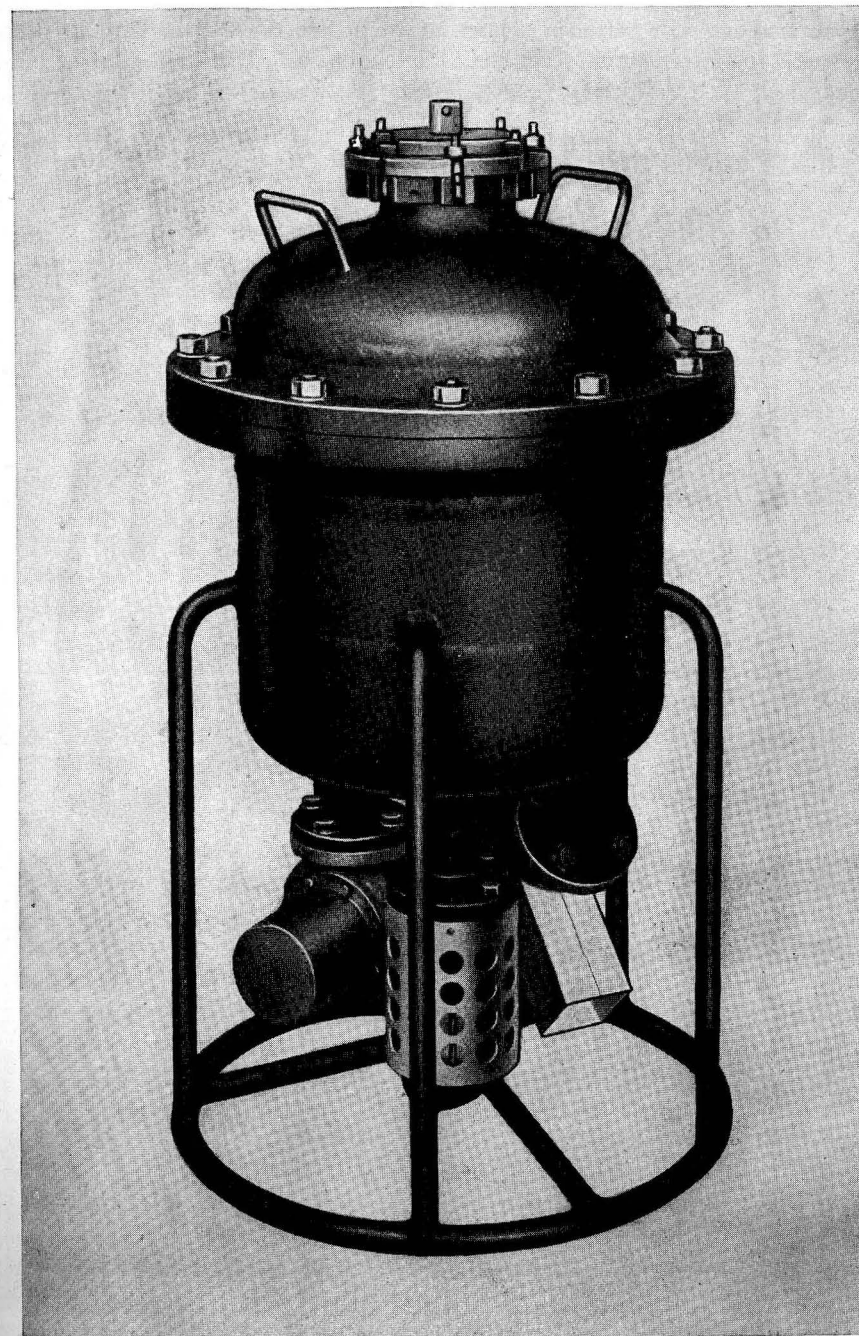
Abb. 5. Sonde, Druck-, Temperatur- und Leitfähigkeitsmeßfühler
