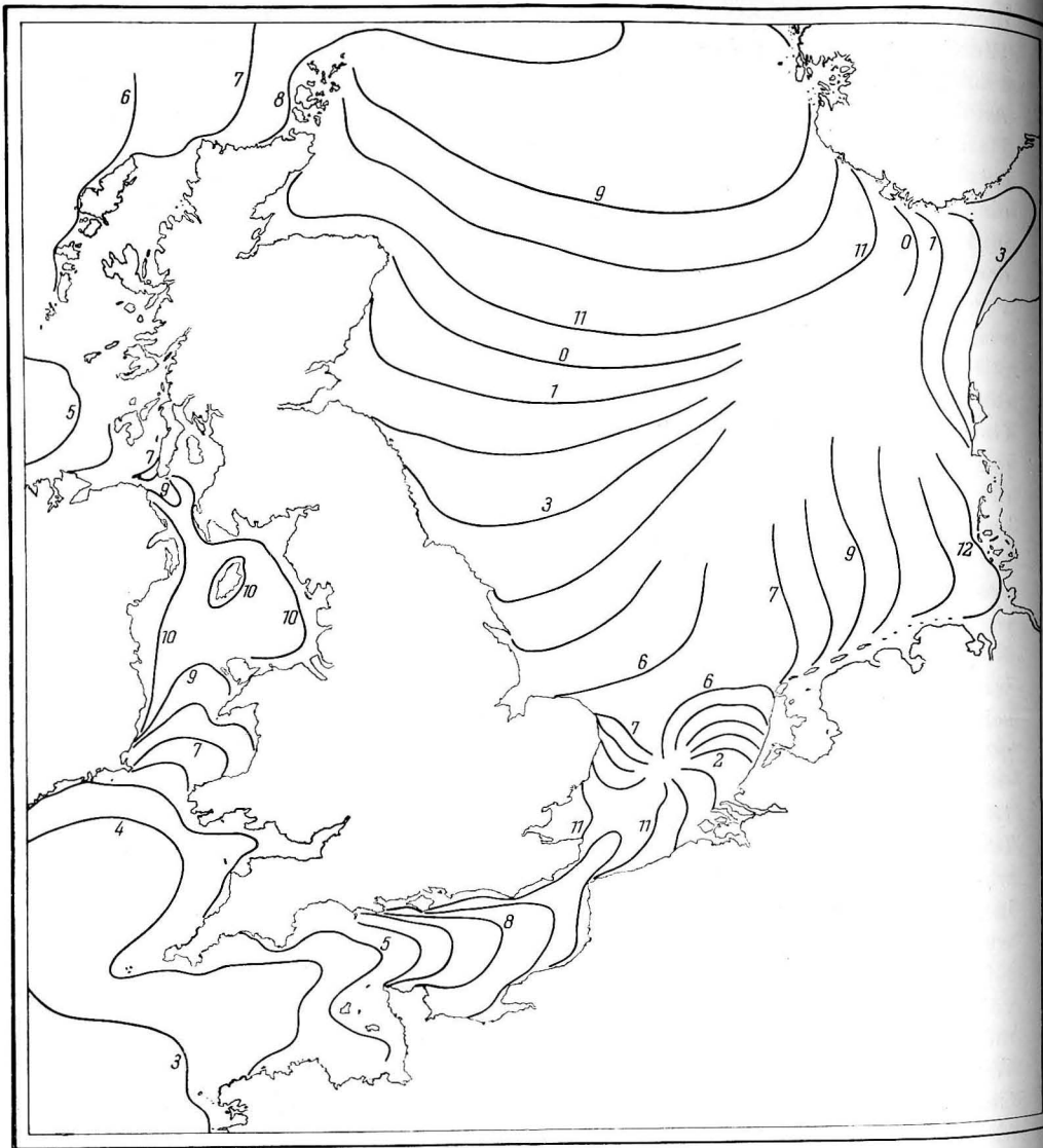
Abb. 8. Der zweite Entwurf einer cotidal chart von WHEWELL aus dem Jahre 1836 (Angaben in Mondstunden)
