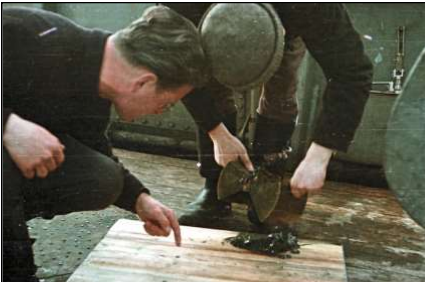
Abb. 5: Untersuchung einer Sedimentprobe an Bord von „Joh. L. Krüger“, gewonnen mit dem PETERSEN-Bodengreifer im Februar 1952 (IOW Photo Archive).
