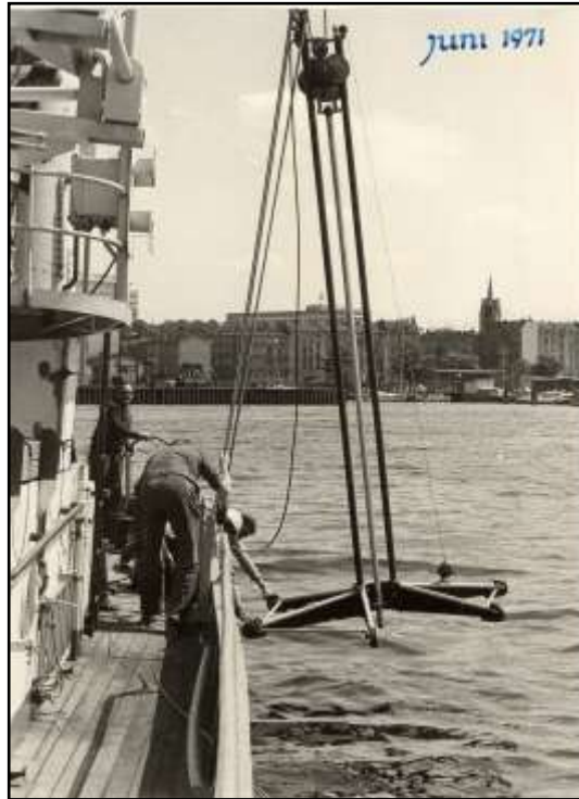
Abb. 18: Erprobung des Vibrationsstechrohrs des Instituts für Meereskunde im Rostocker Stadthafen, ohne Absetzgestell durch Kopplung auch für Kerne bis zu 9 m einsetzbar (Foto: K. SCHMEDEMANN).
