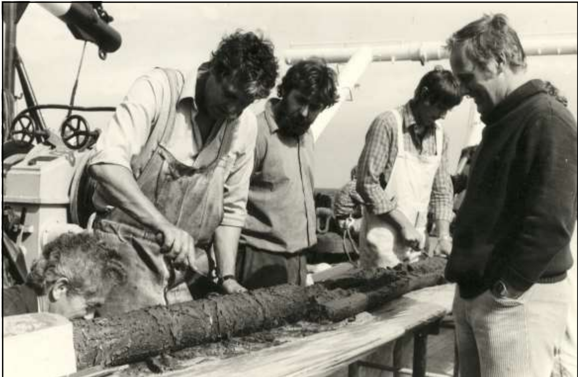
Abb. 21: Untersuchung eines mit dem Vibrationsstechrohr gewonnenen Sedimentkerns; links stehend: GERD BENING, rechts: WOLFGANG MATTHÄUS (IOW-Bildarchiv).
