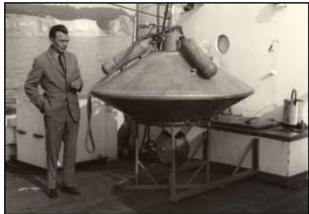
Abb. 20: Auftriebsglocke für das halbautomatische Vibrationsstechrohr an Bord von FS „Professor Albrecht Penck“ (IOW-Bildarchiv).
