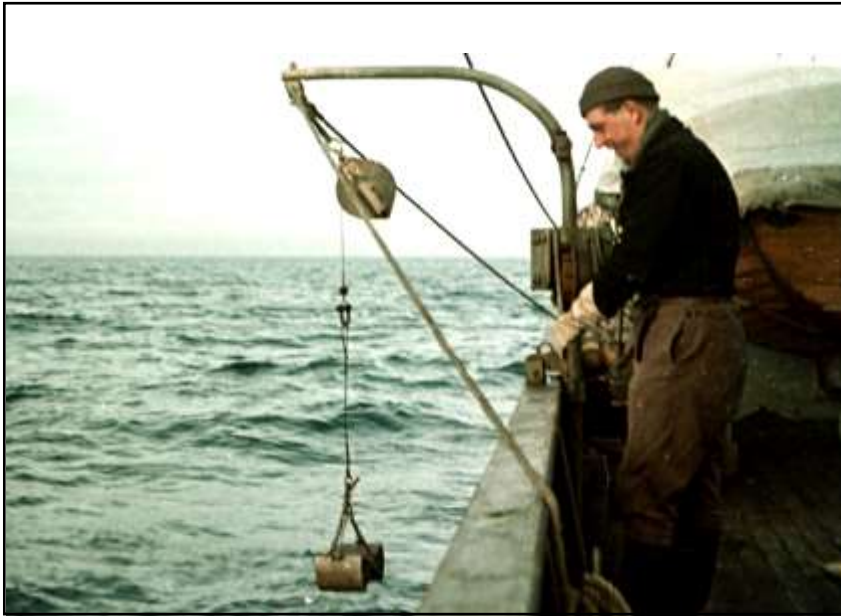
Abb. 4: Arbeit mit dem PETERSEN-Bodengreifer an der Handwinde auf dem Vermessungsschiff „Joh. L. Krüger“ während einer Fahrt im Februar 1952 (IOW-Bildarchiv).
