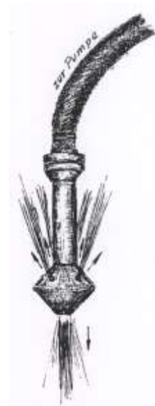
Abb. 9: ERNST PLATZER präsentiert das Sandrohr (oben links), die Unterwasserströmungssonde (oben rechts) und die Spülsonde (unten) mit einfachem und rotierendem (rechts) Spülkopf, die ab 1955 im Einsatz für die meeresgeologische Forschung im Ostsee-Observatorium Warnemünde waren (aus KOLP, 1957C).
