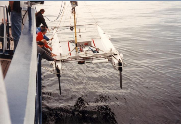
Ein Katamaran, bestückt mit Strahlungssensoren und einem ADCP, wird zu Wasser gelassen um die Schwebstoffwolke zu vermessen.
