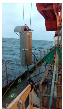
Die 400 l Wasser des Großwasserschöpfers werden nach seinem Befüllen in 200 m Wassertiefe in Großkanister umgepumpt. Über eine Filtrationsanlage werden anschließend die Schwebstoffe aus dem Wasser für spätere chemische Untersuchungen isoliert.
