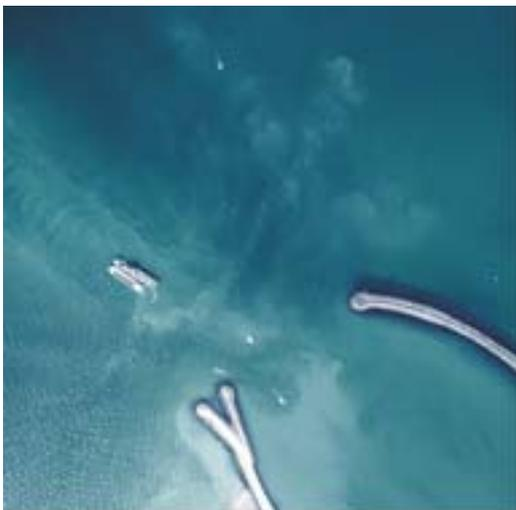
Der Parametrisierung der Modelle dient ein bisher einmaliges Experiment, zu dessen Beginn am 20./21. Juni 2001 5310 m<sup>3</sup> Baggergut in einem Seegebiet vor Kühlungsborn verklappt wurde und das seitdem mit einem speziellen Monitoring-Programm wissenschaftlich bearbeitet und vermessen wird.
