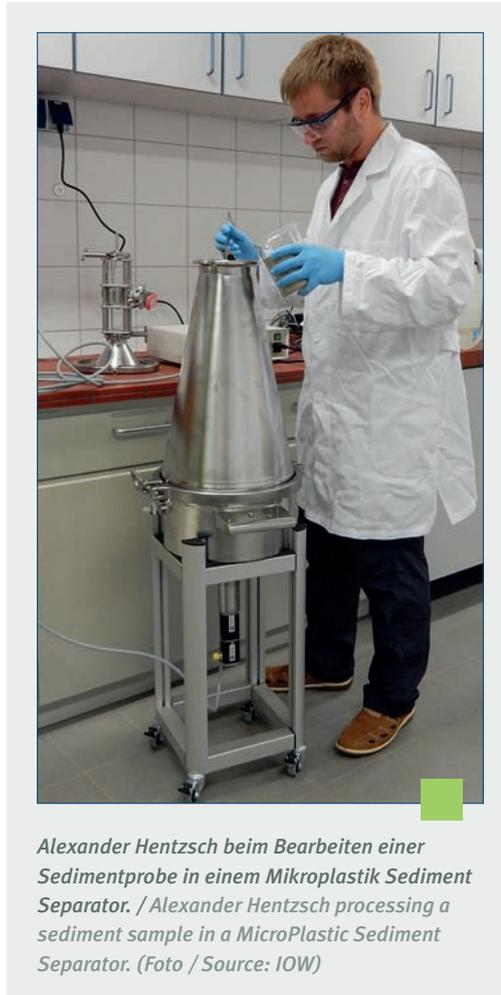
Alexander Hentzsch beim Bearbeiten einer Sedimentprobe in einem Mikroplastik Sediment Separator. / Alexander Hentzsch processing a sediment sample in a MicroPlastic Sediment Separator. (Foto / Source: IOW)
