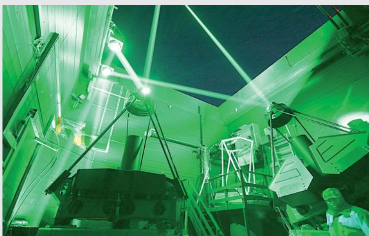
Lichtblitze in der Teleskophalle der Forschungsstation ALOMAR in Nordnorwegen. Die Lichtblitze bewegen sich so schnell, dass sie für das menschliche Auge wie ein durchgehender Strahl aussehen. Damit der Wind in Ost-West- und Nord-Süd-Richtung bestimmt werden kann, werden Lichtblitze in zwei Richtungen ausgesendet.
