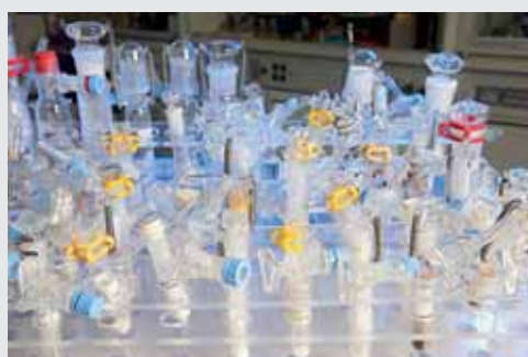
In diesen sogenannten Schlenkgefäßen werden für die Laborarbeit unter Ausschluss von Sauerstoff hochaktive Katalysatoren aufbewahrt.
