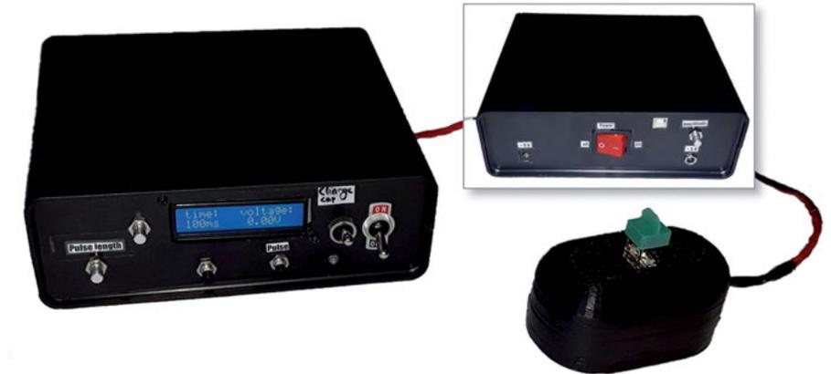
*Vorder- und Rückansicht (r.) des Portoporators mit angeschlossenem Küvettenhalter. Das Gerät ist kleiner als eine Schuhschachtel und wiegt nur 700 Gramm.*
