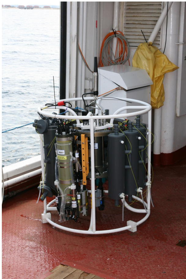
Abbildung 3.6: Foto der Seabird CTD SBE 911 mit Rosette an Deck der RV JHC Miljoe (Mohrholz et al. (2010)).
